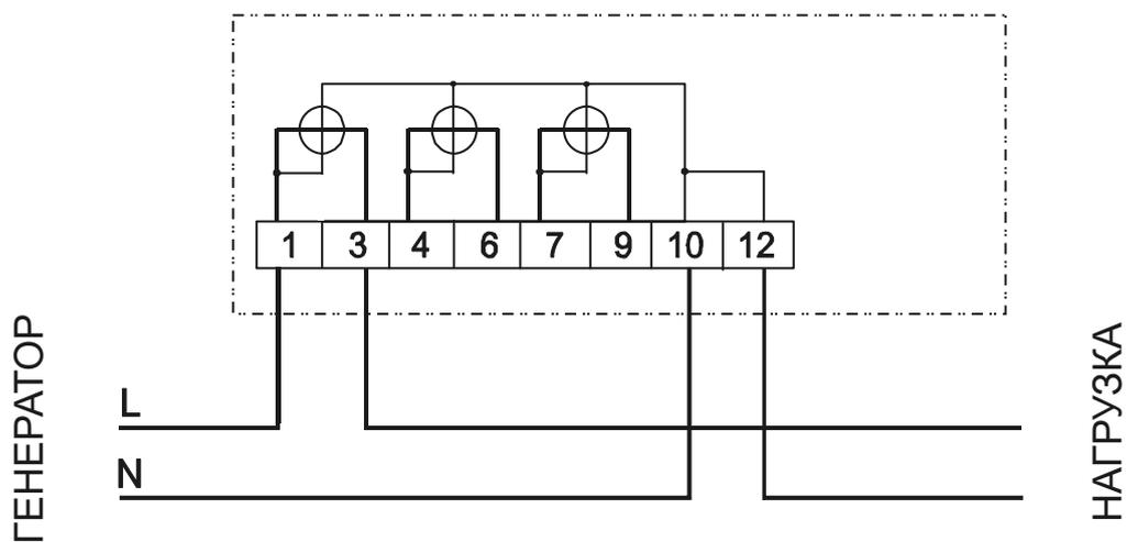
Рисунок 12.3 - Схема подключения счетчика непосредственного включения в однофазную сеть
