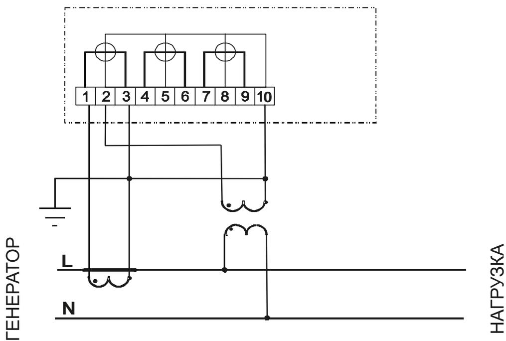
Рисунок 12.4 - Схема включения трехэлементного счетчика в однофазную сеть
