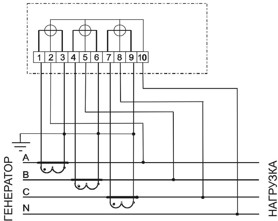
Рисунок 12.5 - Схема включения трехэлементного счетчика в четырехпроводную сеть напряжением 0,4 кВ через трансформаторы тока
